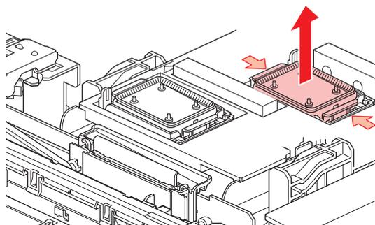
**5** 【Sbインク、TPインクの場合】メンテナンス液を溜めた容器でキャップのメッシュの面を下にしてゆすいでください。取り出したら樹脂部分はしっかりと拭き取ってください。
