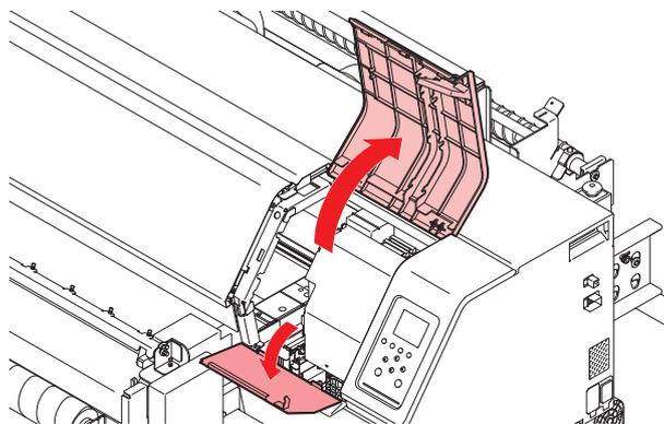
**4** ネジ (x2) を外して、キャップカバーを外す。
