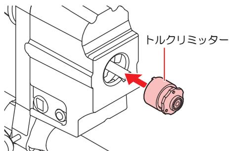
(2) 図のように、繰り出し/巻き取りユニットのシャフトの先端とトルクリミッターの面が一致するように取り付ける。
