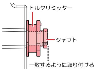
(3) ツマミネジでトルクリミッターを固定する。
