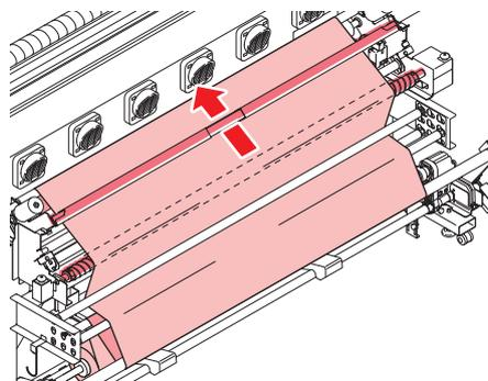
(2) 持ち手を両手で持ってロックスライダ（左右）を内側に移動し、加圧ローラーをゆっくり下げてください。
