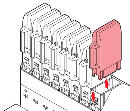
**2** 吸収材を外して、新しい吸収材をセットする。
